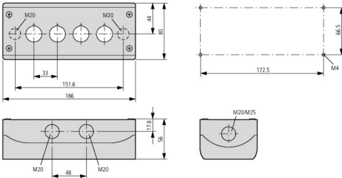
Entrée de câble prédécoupée : en bas 2 x M20 ; en haut : 2 x M20, côté : 2 x M20/M25 (1 par côté)
