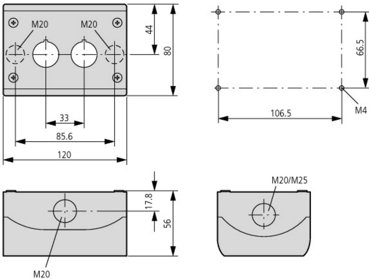
Passage de câble prédecoupée : en bas 2 x M20 ; en haut : 1 x M20, côté : 2 x M20/M25 (1 par côté)
