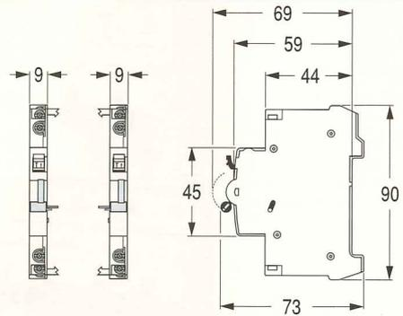
Module de déclenchement à distance - Tele L
