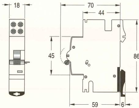
Déclencheur à minimum de tension - Tele U
